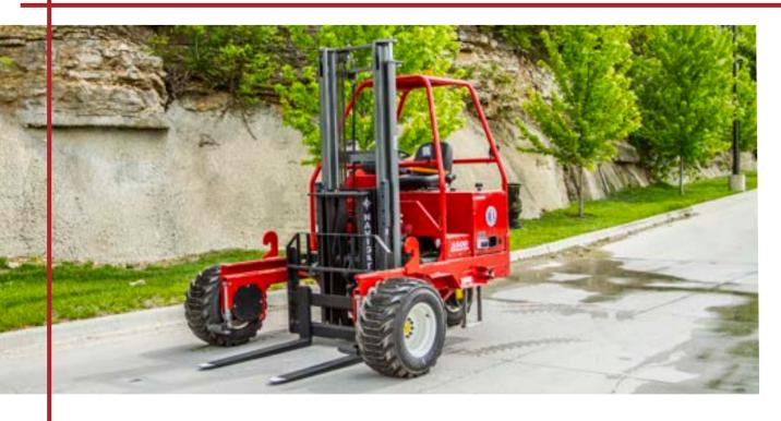
5500 LBS. @ 24IN. LOAD CENTER DOUBLE STAGE MAST, 144IN. LIFT HEIGHT 104.5IN. OVERALL HEIGHT 75IN. MOUNTED OVERHANG 100IN. MACHINE WIDTH 5800 LBS. DRY WEIGHT 8° MAST TILT 5IN. SIDE SHIFT **60IN. FRAME OPENING** 30IN. MAST TRAVEL 31X15.5X15 TIRES (3) HYDROSTATIC DRIVE 60HP KOHLER DIESEL TIER FOUR ENGINE 8 MPH MAX TRAVEL SPEED **BACK UP ALARM** 48IN. LUMBER FORKS TIRE SEALANT PARKING BRAKE STROBE LIGHT LOAD BACKREST
